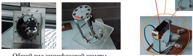
Общий вид низкофоновой камеры (слева) и крепление основных узлов на фланце ΔE-E телескоп полупроводниковых детекторов
