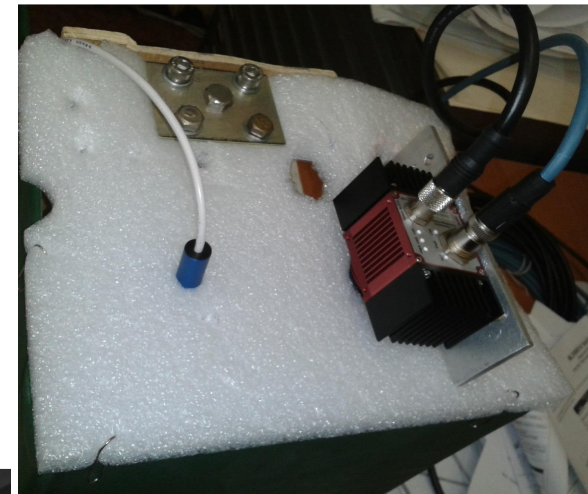
Рис.2. 3D-камера C2-640-GigE, алгоритм COG (center of gravity) для вычисления центра линии
