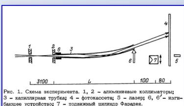
Рис. 1. Схема эксперимента. 1, 2 – дополняемые коллиматоры; 3 – капиллярная трубка; 4 – фотокаソード; 5 – лазер; 6, 6' – изгибающее устройство; 7 – подвижный щит Фарадея.
