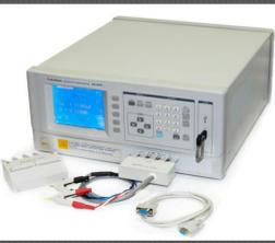
Рис. 11. Фотография измерителя «RLC Aktakom AM-3028»
