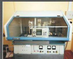
Рис. 6. Фотография рентгеновского дифрактометра «ДРОН-3»
