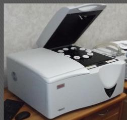
Рис. 10. Фотография энергодисперсионного рентгенофлуоресцентного спектрометра «ARL QUANT'X»
