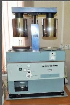
Рис. 4. Фотография стационарной термовесовой установки «Дериватограф Q - 1000»
